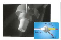
圧縮空気の力で投射材をノズルから 投射する方式です。 局部的な処理に適しています。
